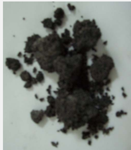
常熟电厂冷炉斗灰——含碳量1.3%（烟煤） 齐鲁石化电厂冷炉斗灰——含碳量19%（贫煤/混煤）
