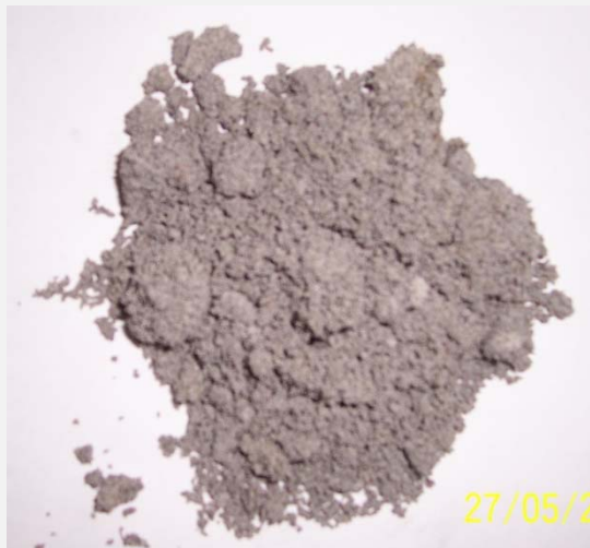
常熟电厂冷炉斗灰——含碳量1.3%（烟煤） 齐鲁石化电厂冷炉斗灰——含碳量19%（贫煤/混煤）
