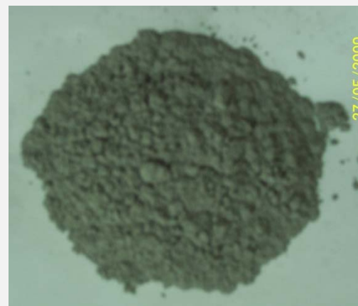
贾旺电厂飞灰——含碳量10%（混煤）
