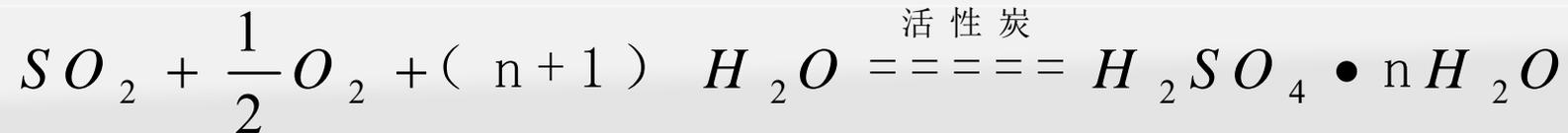
生成的硫酸覆盖在吸附层的活性表面，降低了活性炭的吸附能力，当达到饱和状态时，活性炭将完全丧失其吸附作用，为了使活性炭再生，必须进行**解析**。一般采用洗涤方法脱附，既可以使活性炭再生，还可以回收硫酸。
